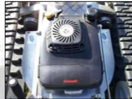
FJ180V 6CV à lubrification sous pression
