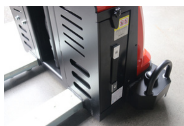
Accès à la batterie via trappe latérale
