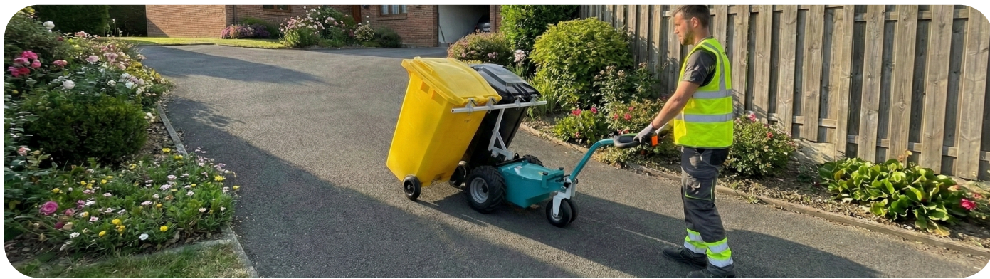
Tracteur pousseur adapté pour la manutention de conteneurs poubelles
