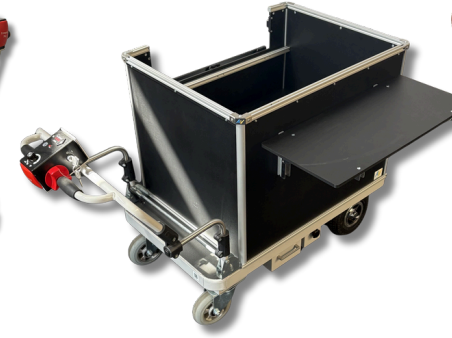
Bac motorisé en déplacement avec poignée adaptée aux fauteuils roulants
